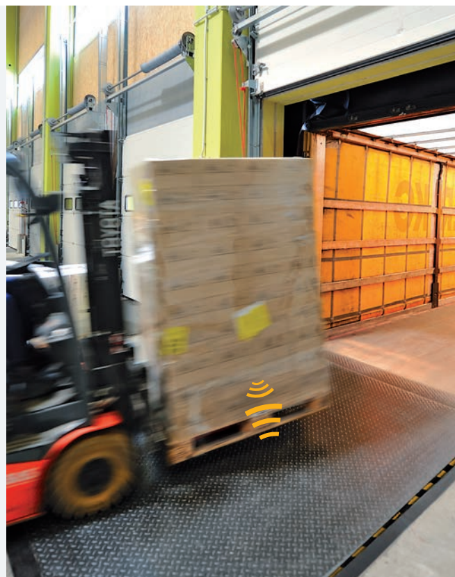
货盘经过平台台面时，扫码器自动读取磁条上的货物信息
